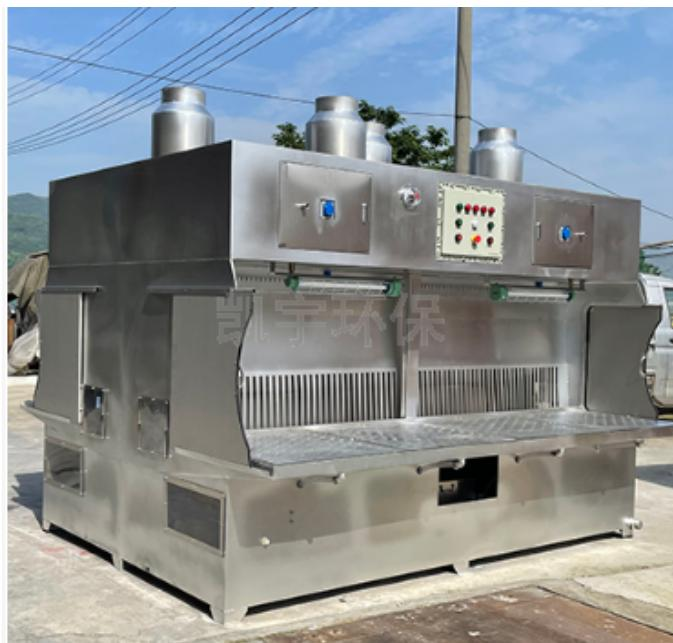
湿式除尘设备的种类很多，很难有一个准确的分类。概括地可分为低阻力和高阻力的湿式除尘器。前者阻力是25-150毫米水柱，它包括简单喷雾塔与湿式旋风除尘器，一般的耗水量是0.4-0.8公斤/立方米，当粉尘大于10微米时的除尘效率超过90-95%。凯宇湿式除尘设备，除尘效率可以达到98%以上，阻力损失在250-875毫米水柱。瑞安市凯宇环保设备有限公司是一家专业生产各类环保设备的厂家，其产品普遍运用于五金打磨、建材制造、化工制药、石化、机械加工、家居木工等行业的环保防尘治理上。除尘设备，你选对了吗？关注凯宇环保，带你走进环保世界，了解行业动态！解读全新资讯！北京五金抛光机瑞安市凯宇环保设备有限公司致力于提供环保抛光机设备，竭诚为您服务。
