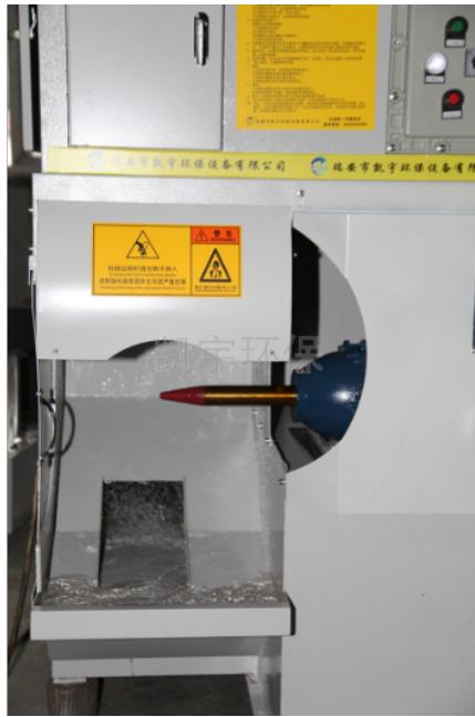
湿式打磨防爆除尘一体抛光机是凯宇环保经过多年研发、跟随环保环保十三五规范，避免抛光带来的环境污染，设备由抛光机结构体、吸尘结构体、水循环结构体、离心风机结构体、均采用防爆装置处理、安全可靠、设备体积小、安装便捷、抛光除尘率达98%，是一款不错的除尘抛光机、湿式收尘技术通过压降来吸收附着粉尘的空气，在离心力以及水与粉尘气体混合的双重作用下除尘；独特的叶轮等关键设计可提供更高的除尘效率。主要表现： • 机性能优越，外形美观，稳定性高，若无地脚螺丝装置，仍可稳定操作，且机器不会移动； • 加工轮护罩可根据需要调整角度，使加工起来更具灵活性； • 机器附有吸尘装置，降低粉尘污染，符合环保要求； • 可安装不同加工轮，如布轮、尼龙轮、砂布丝轮、干叶轮等。 • 可根据需要安装变频装置，改边切削线速度，可适合不同材质加工。
